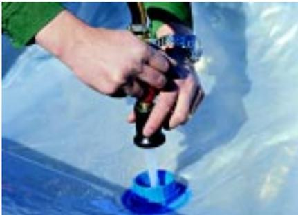
Befüllung mit niedrigem Druck: Bringen Sie den Wassersack in Würfelform. Verwenden Sie dabei das vorhandene Klebeband. Befüllung mit hohem Druck von oben oder unten: Bringen Sie einen Füllschlauch an.
