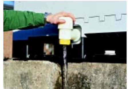
Setzen Sie vor Ort den Wasserhahn an und verteilen Sie das Wasser. Der Hahn auf der Abbildung verfügt über eine einfache Drosselungsvorrichtung, die einen schmalen Wasserstrahl ausgibt.
